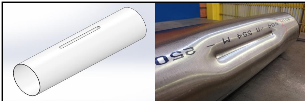
Figura 14: Geometria projetada x obtida
