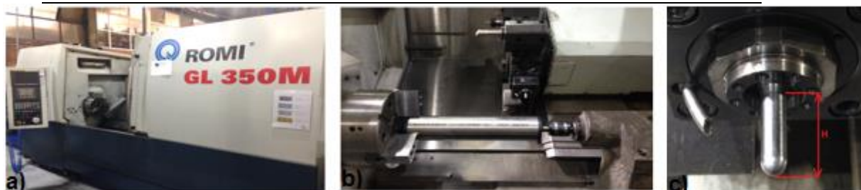
Figura 5: a)Torno CNC utilizados nos experimentos. b) Sistema de fixação. c) Ferramenta utilizada
